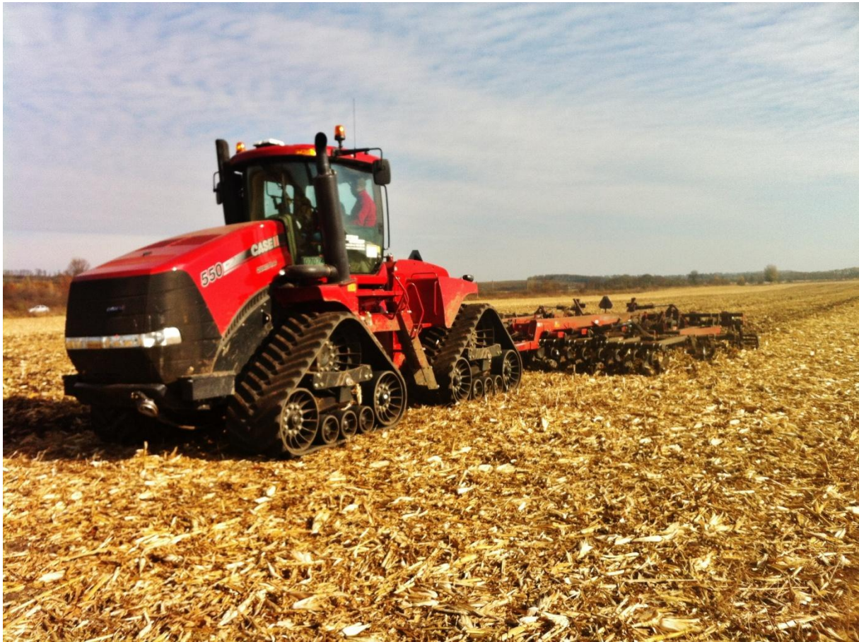
Abbildung 4: Raupenfahrwerk mit 5,6 m 2 Aufstandsfläche und Kombination von Scheibenegge mit Tiefenlockerer
